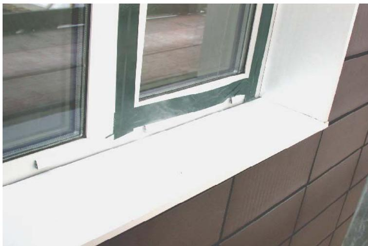
*Abbildung 85 - Luftundichtigkeit am Fenster durch Kunstnebel sichtbar gemacht*
