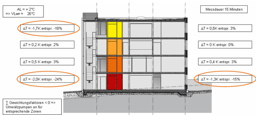
Abbildung 36 - Beispiel für die bedarfsorientierte Regelung
