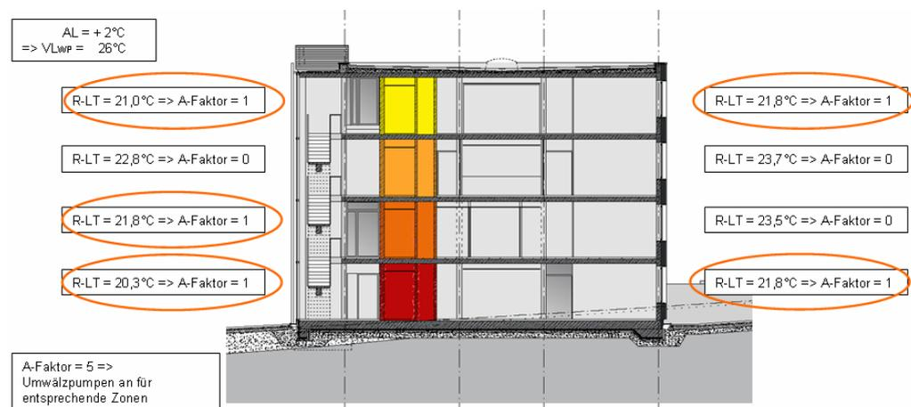
Abbildung 35 - Beispiel für die Regelung mit der Lufttemperatur als Führungsgröße
