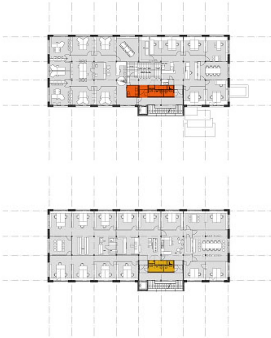
Abbildung 5 - Nutzungsflexibilität durch Teilung der Geschosse EG bis 2.OG
